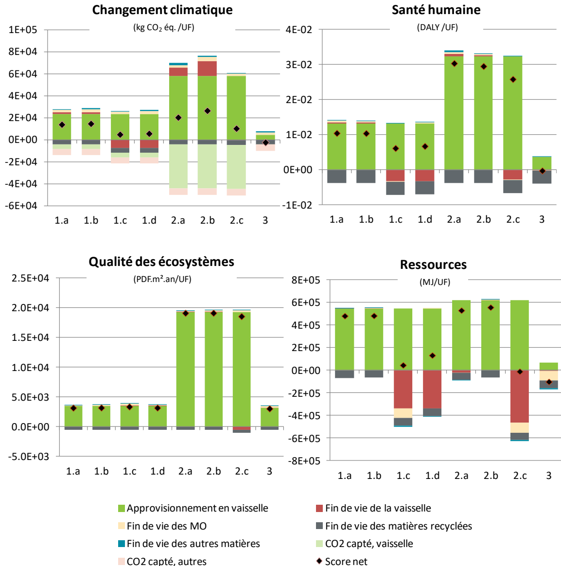
Figure 3-15 : Comparaison environnementale de scénarios d'approvisionnement en vaisselle et de gestion des matières résiduelles générées dans les aires de service alimentaire (méthode IMPACT 2002+).
