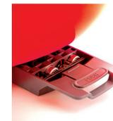
::: en suivant la polarité indiquée, insérer quatre piles AA dans le compartiment des piles situé sur le côté inférieur droit du boîtier
