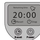
3- Une fois le temps de fonctionnement est réglé, appuyer sur le bouton Power (🔌) pour mettre l'appareil en marche. Le panneau de contrôle affichera le temps à turbine restant (Remaining time).
