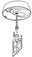
4- Séparer le bras mélangeur de la pièce connectrice. Lors de la première utilisation de la machine à crème glacée, le bras mélangeur se trouvera dans le bol refroidisseur.
