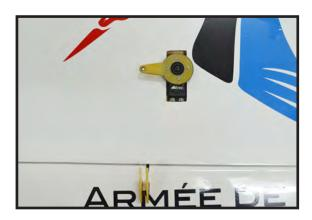
INSTALLING THE AILERON PUSHROD.
