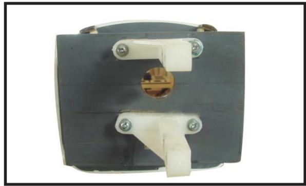
**INSTALLING THE STOPPER ASSEMBLY.**
